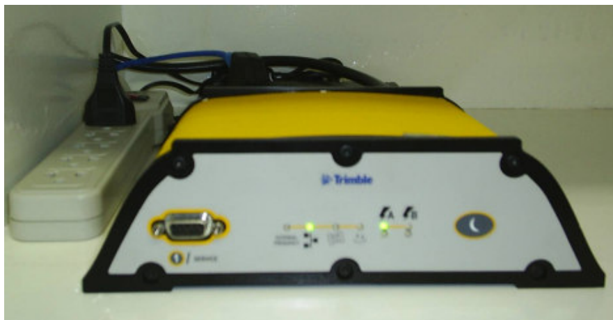
Figura 32 – Receptor GPS de duas freqüências que serve como estação de referência
