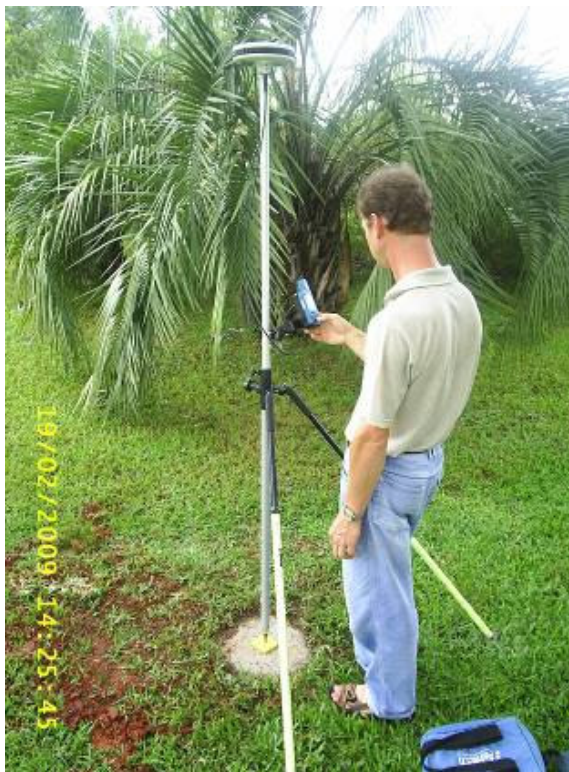
Figura 27 – Rastreio do marco com receptor GPS L1
