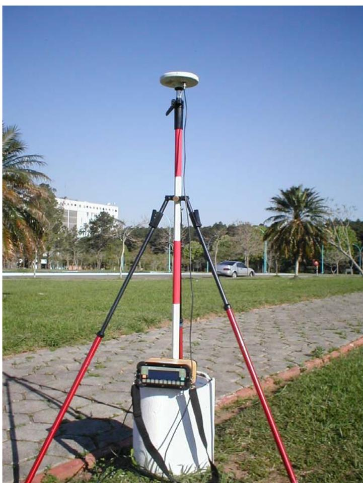
Figura 13 – Coleta de dados com GPS L1.
