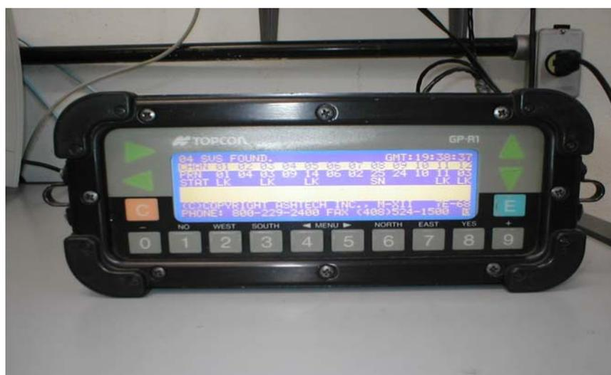
Figura 12 – Receptor GPS, L1, marca Topcon, modelo GPR.
