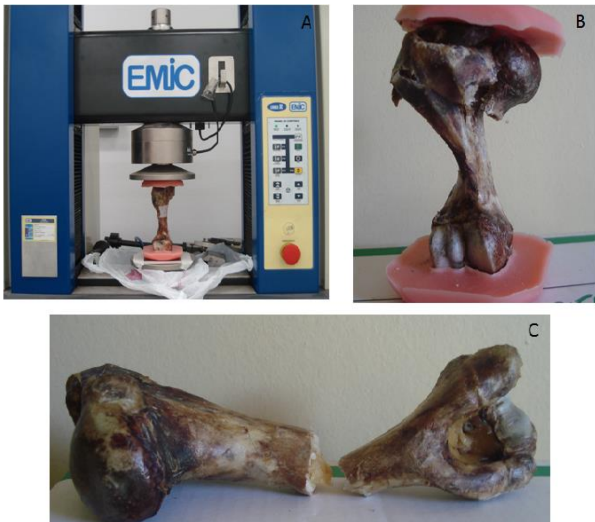
Figura 1 - Em A, imagem durante o ensaio de compressão em úmero fresco de suíno. Em B, imagem do osso com fratura metafisária após compressão. Em C, fratura na diáfise umeral no ensaio de flexão.
