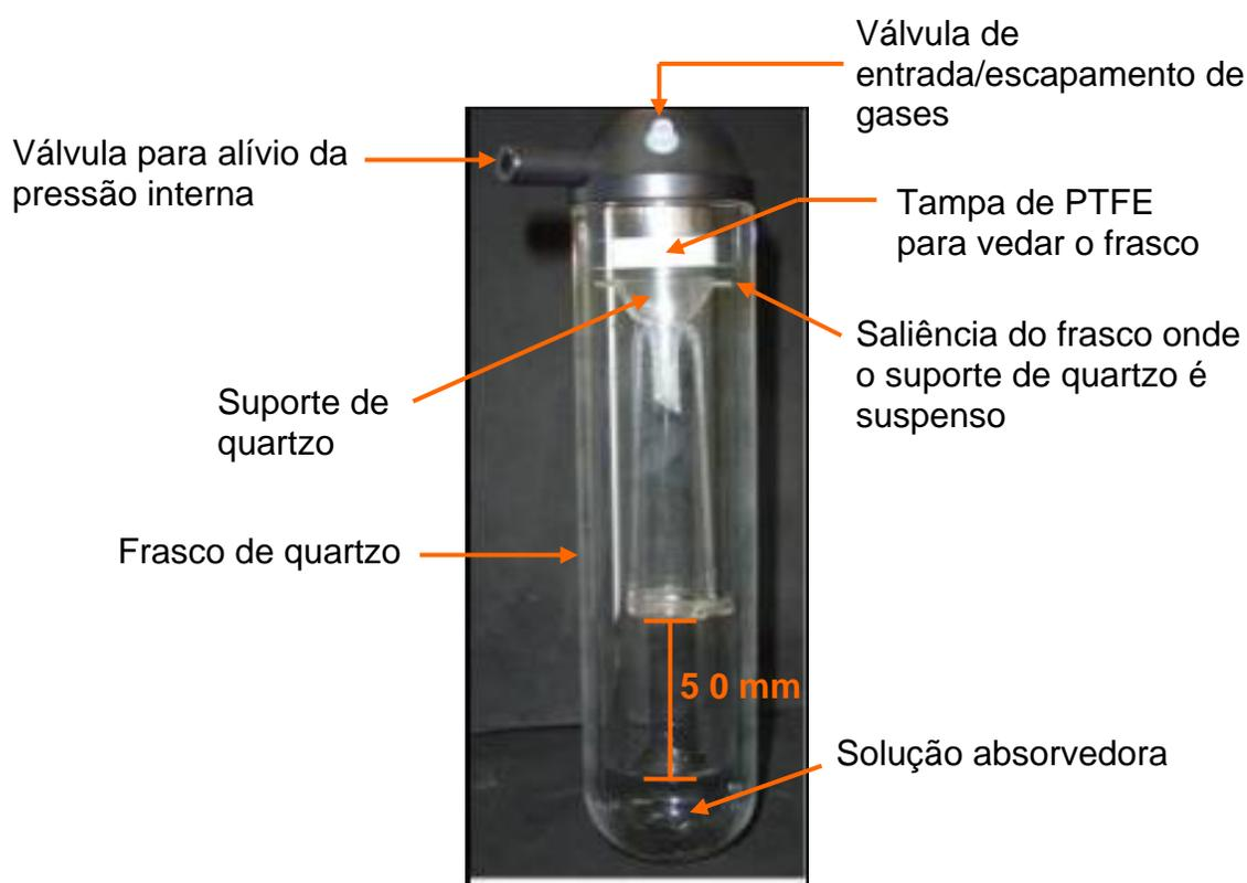
**Figura 16.** Sistema de decomposição por combustão iniciada por microondas (adaptado de Mesko).<sup>51</sup>
