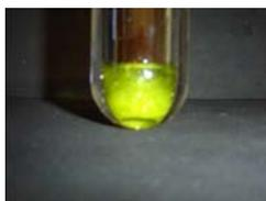
**Figura 20.** Solução resultante após decomposição com HNO<sub>3</sub> em forno de microondas comercial *Multiwave 3000*<sup>®</sup>.
