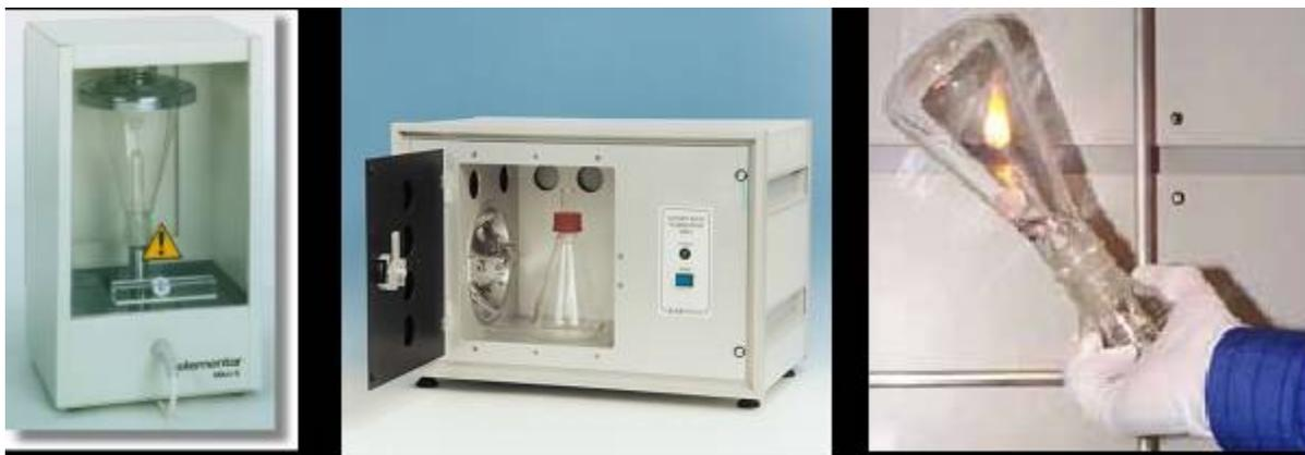
**Figura 5.** Frasco de combustão de Schöniger: sistema com ignição (a) elétrica<sup>19</sup> (b), infravermelha<sup>16</sup>, (c) manual.
