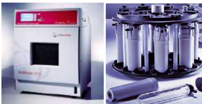
Figura 7. Forno de microondas comercial e frascos de quartzo utilizados para a decomposição das amostras por via úmida e combustão.
