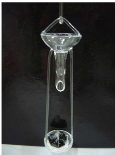
Figura 9. Amostra de petróleo extrapesado envolvida em polietileno e posicionada na base do suporte de quartzo utilizado.
