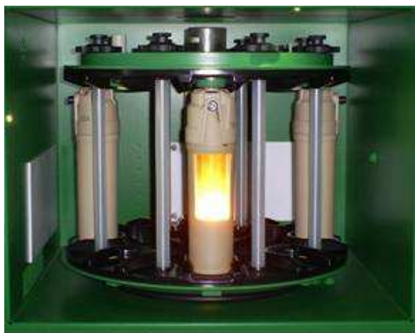
Figura 14. Decomposição de 300 mg de coque pelo sistema de combustão utilizado.
