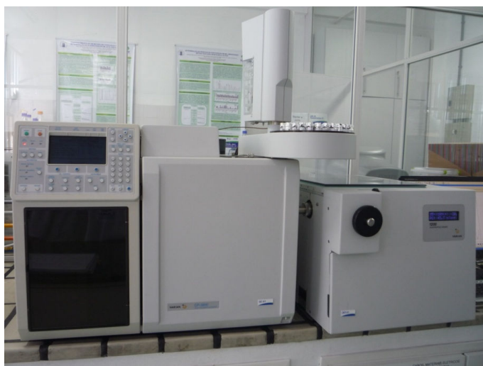
Figura 4: Sistema GC-MS/MS utilizado para o desenvolvimento deste trabalho.
