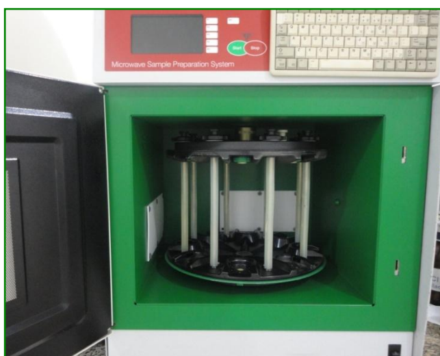
Figura 6. Forno de micro-ondas e rotor utilizados para o procedimento de decomposição de sulfato de bário.
