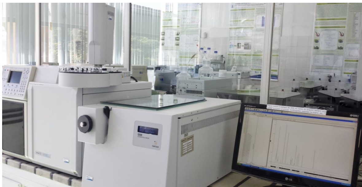
Figura 7: Sistema GC-MS/MS triploquadrupolo utilizado no estudo
