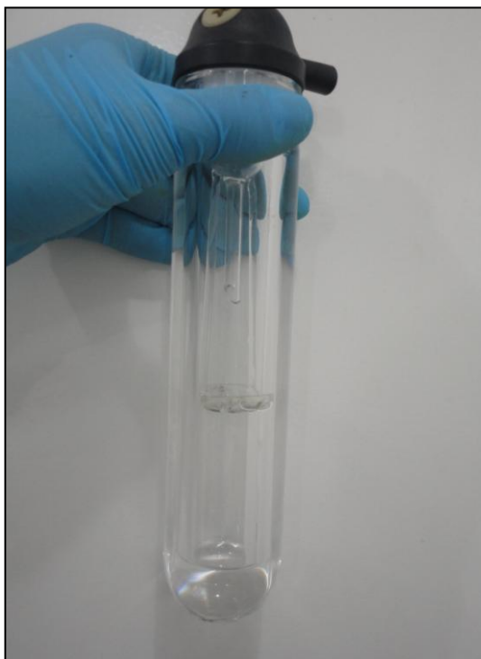
Figura 24. Frasco com suporte de quartzo após decomposição por MIC de 100 mg de grafite flexível “A” com 300 mg de celulose, na forma de comprimido, empregando \text{HNO}_3 14 \text{ mol L}^{-1} e 20 bar de \text{O}_2 .
