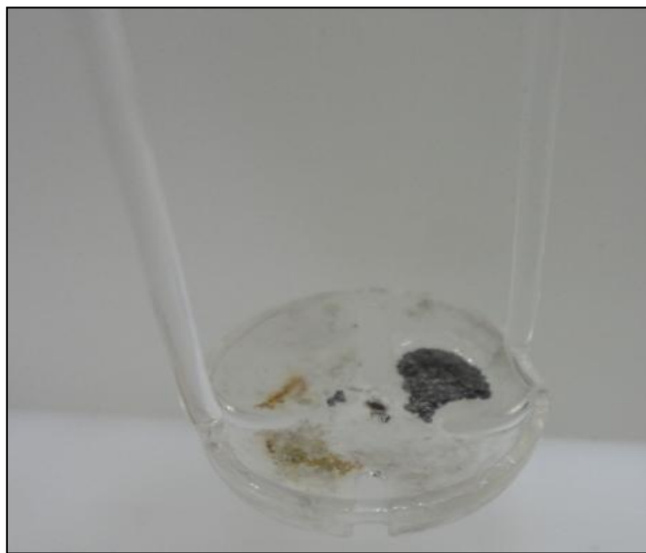
Figura 23. Amostra de grafite flexível “A” na forma de comprimido (100 mg de amostra e 200 mg de celulose) após decomposição por MIC com \text{HNO}_3 14 \text{ mol L}^{-1} e 20 bar de \text{O}_2 .
