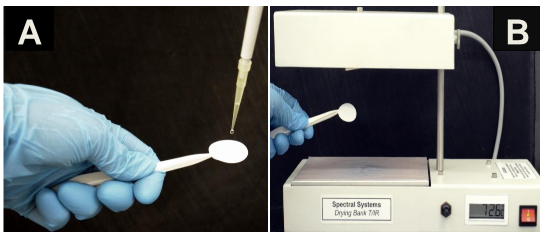
Figura 9. (A) Procedimento de adição da solução de referência sobre o disco de náilon e (B) secagem do disco de náilon com aquecimento por infravermelho.
