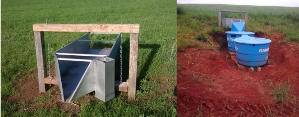
Figura 6 -. Vertedor tipo H e tanques de coleta
