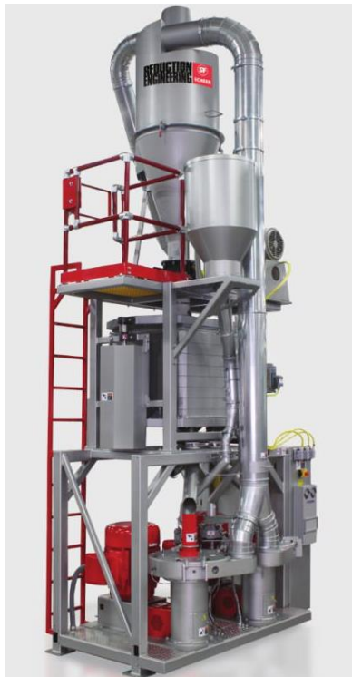
Figura 20 – Micronizador marca Reduction Engineering Scheer modelo U400.
