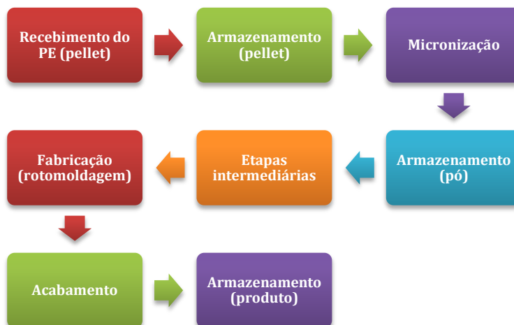
Figura 18 – Fluxo produtivo estabelecido para simulação do processo de rotomoldagem.
