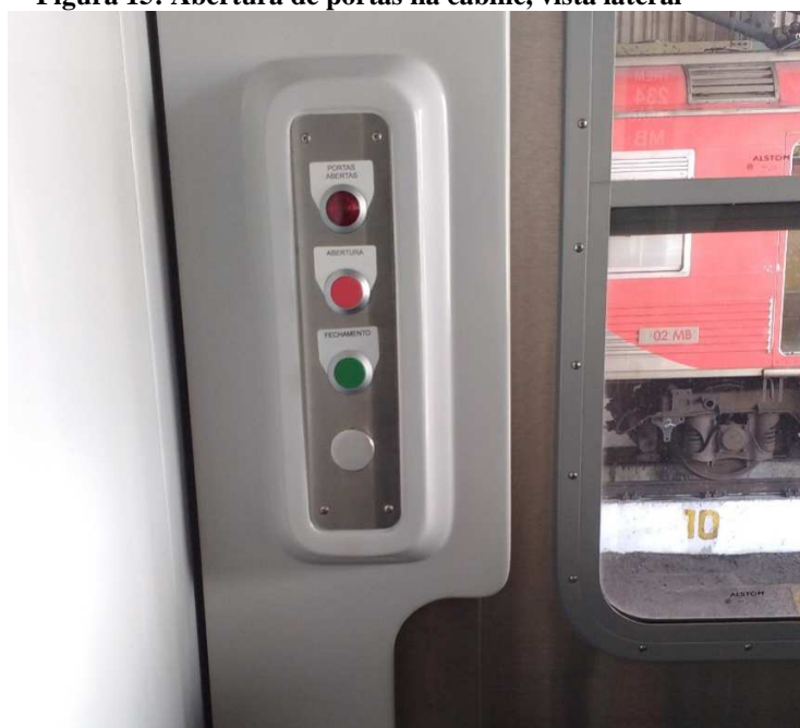
Figura 15: Abertura de portas na cabine, vista lateral
