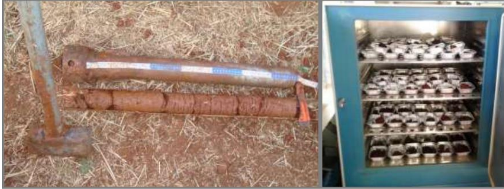
Figura 4 - Amostragem de campo de um monólito de solo com posterior segmentação e secagem das amostras para o inventário de ^{13}\text{C} , C total e ^{137}\text{Cs} .
