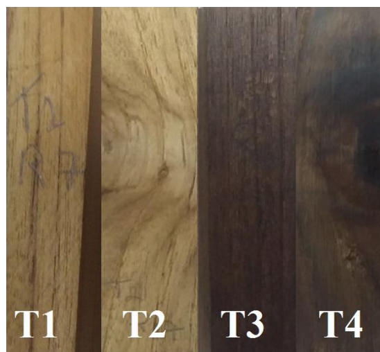
Figura 3.10 - Aspecto visual da madeira de Tectona grandis avaliados na colorimetria
