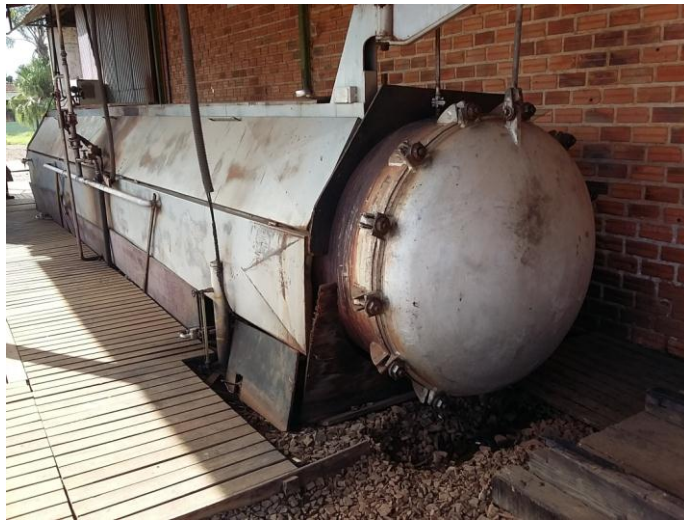
Figura 1.12 - Visão geral do cilindro utilizado no processo de modificação térmica
