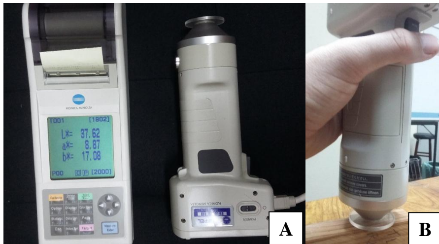
Figura 3.1 - Colorímetro portátil Konica Minolta, modelo CR-400 (A) e aplicação do teste no corpo de prova (B)
