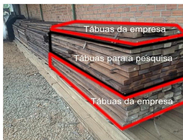
Figura 1.14 - Esquema da pilha de madeira utilizada na modificação térmica
