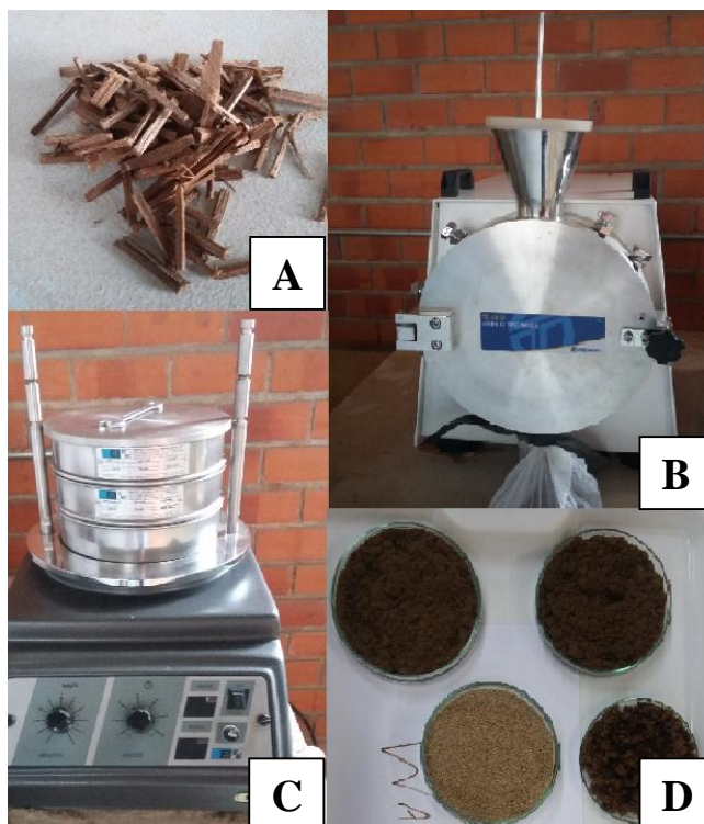
Figura 2.1 - Amostras de madeira em palito (A), moinho de facas do tipo Willey (B), agitador eletromagnético de peneiras acopladas (C), amostras classificadas (D)
