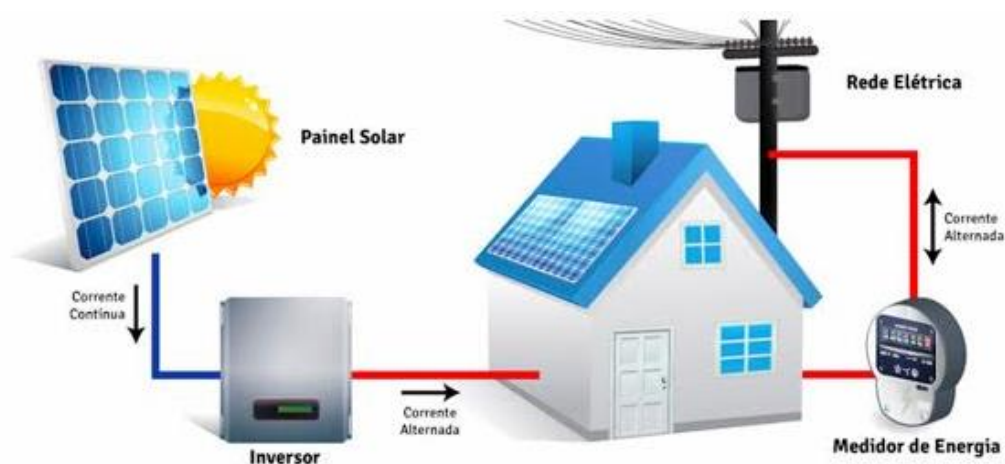
Figura 24. Gerador fotovoltaico conectado à rede de distribuição.
