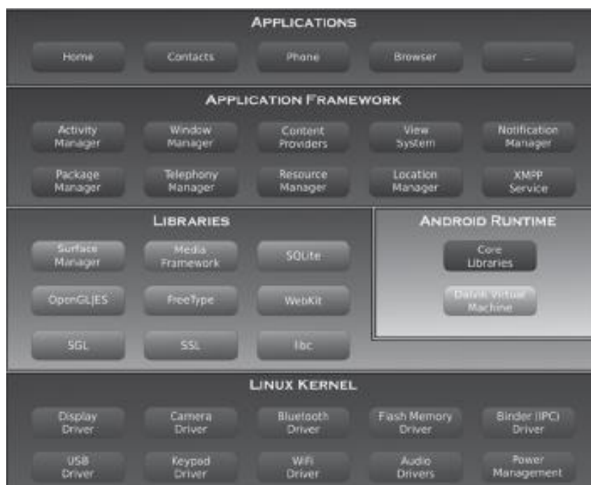
Figura 5: Arquitetura do Sistema Operacional Android (Fonte: PLOTZE, 2015)
