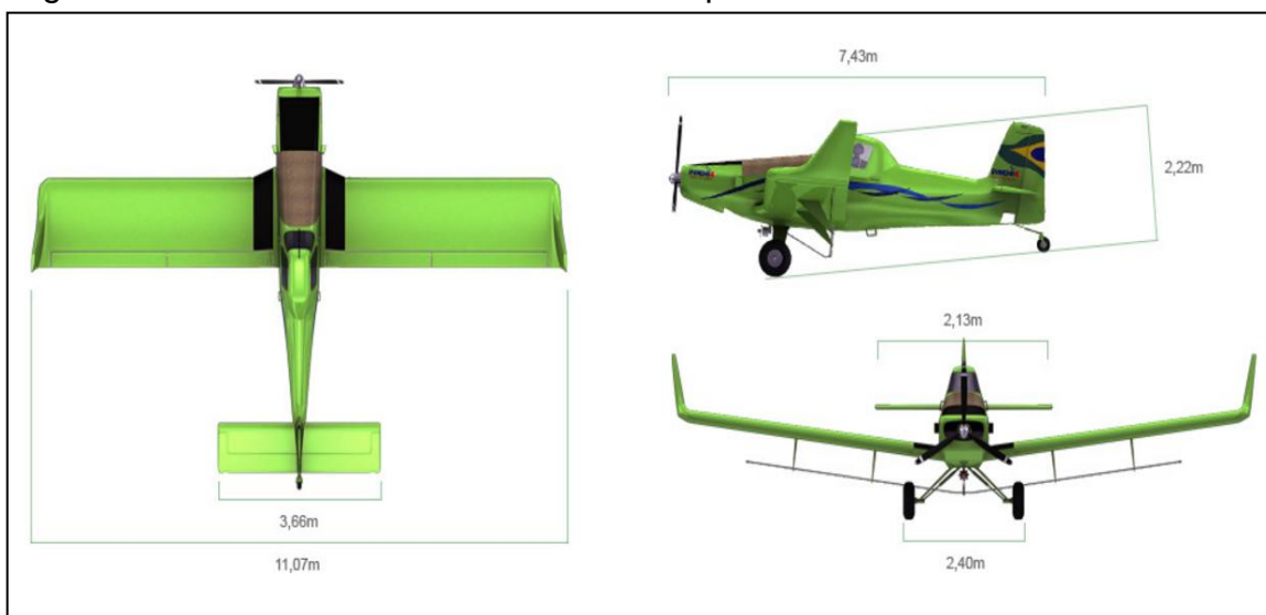
Figura 10 – Desenho técnico e medidas do Ipanema ® .
