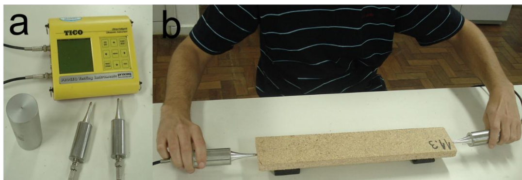
Figura 1 – Equipamento de ultrassom com transdutores de pontos secos (a); Ensaio de propagação direta (b).
