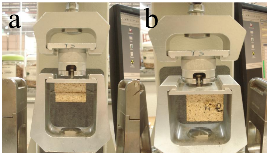
Figura 2 – Ensaio de arrancamento de parafusos na face (a); ensaio de arrancamento parafusos no topo (b).
