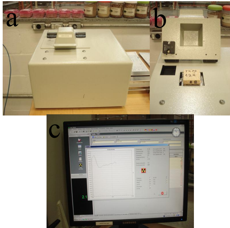
Figura 2 - Densitômetro de raios X (a); detalhe do posicionamento do corpo de prova antes de ser introduzido na câmara (b) e formação do gráfico de perfil de densidade (c).
