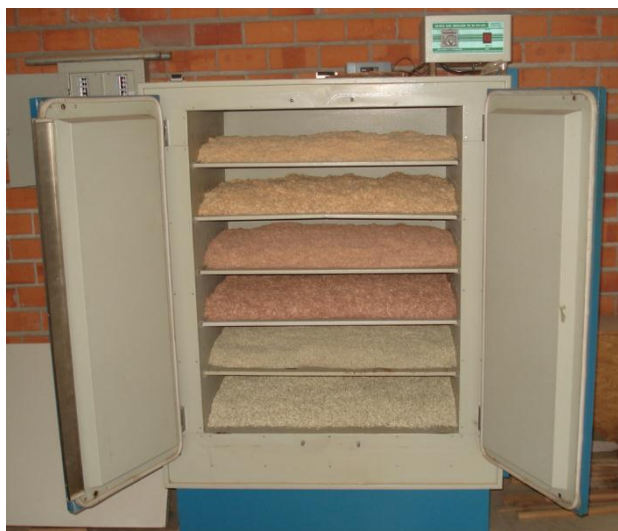
Figura 16 – Secagem das partículas em estufa.
