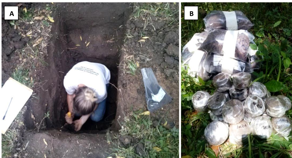
Figura 7 – 7A - Realização de coleta de amostras preservadas e não preservadas de solo em trincheira; 7B - Coletas de solo embaladas e identificadas para posterior armazenamento e transporte em São Gabriel, RS.
