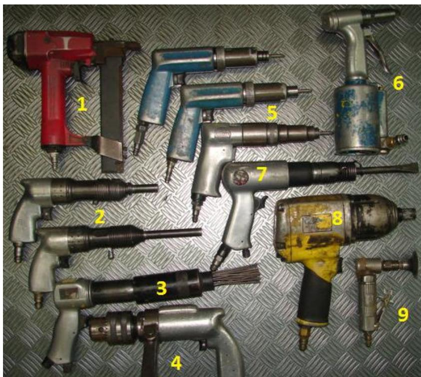
Figura 4: Ferramentas pneumáticas do tipo (1) grampeador pneumático, (2) martelete pneumático, (3) escovador pneumático, (4) furadeira pneumática, (5) parafusadeira tipo pistola, (6) rebiteira pneumática, (7) martelete p/ cortar rebite, (8) parafusadeira  $\frac{3}{4}$ , (9) lixadeira pneumática.
