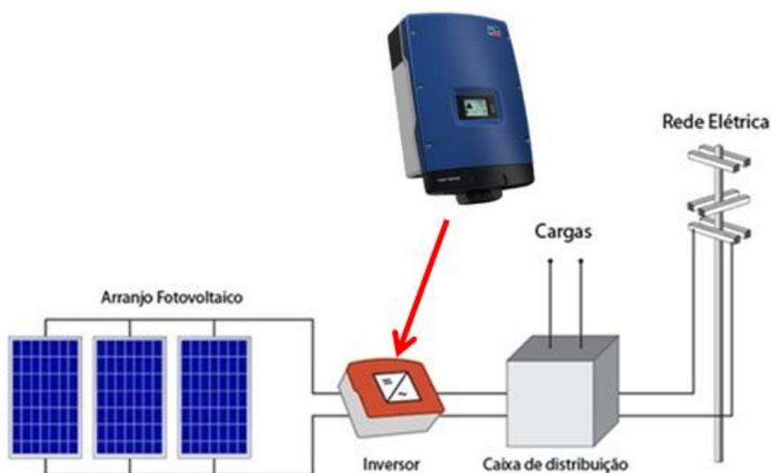
Figura 15 – esquema de funcionamento de microgeração de energia através de módulos fotovoltaicos. Fonte: Arquivo da área de Manutenção da empresa.
