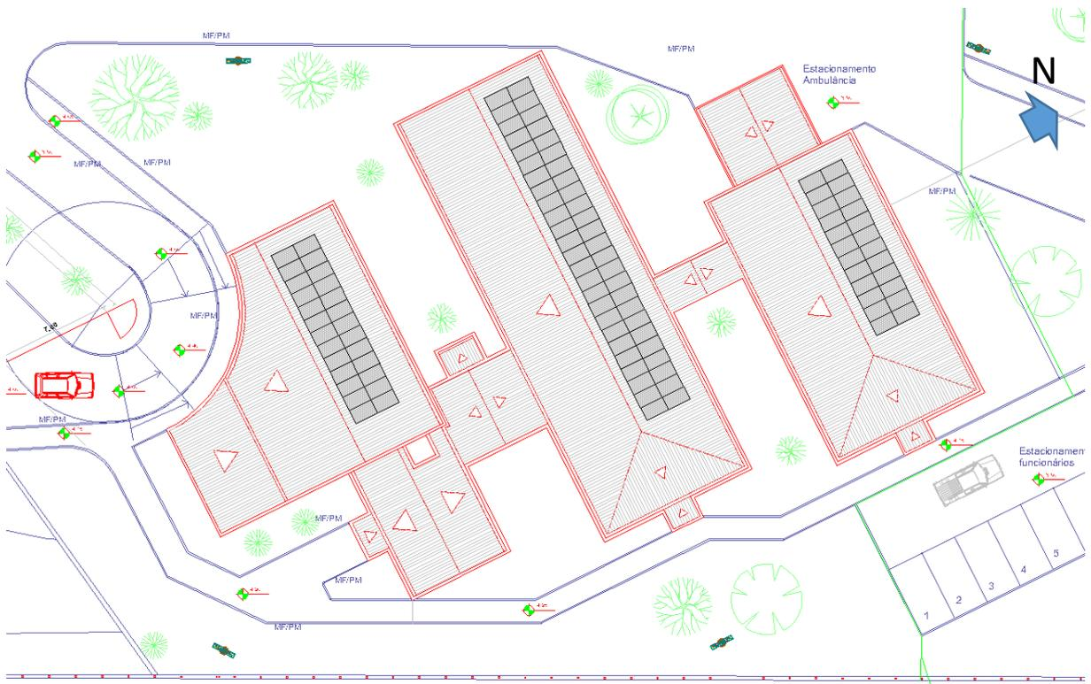
FIGURA 9 - Planta de cobertura – Projeção da distribuição dos painéis (sem escala).
