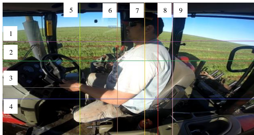
Figura 8 - Representação dos pontos para medição de ângulos, em operador de máquinas agrícolas.
