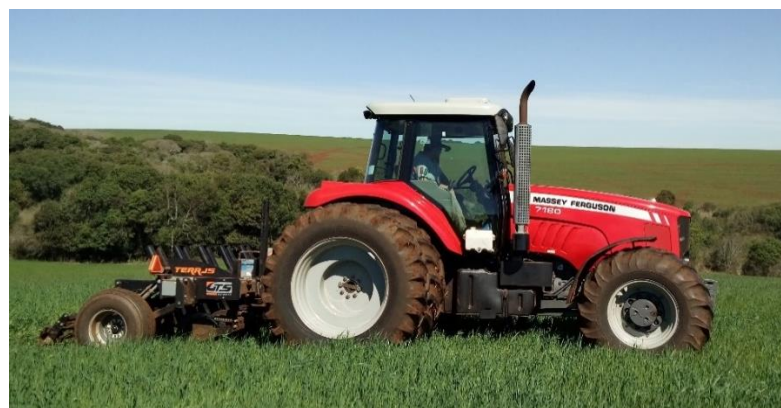
Figura 5 – Conjunto trator-subsolador, no preparo de solo, em Boa Vista do Inara, RS.
