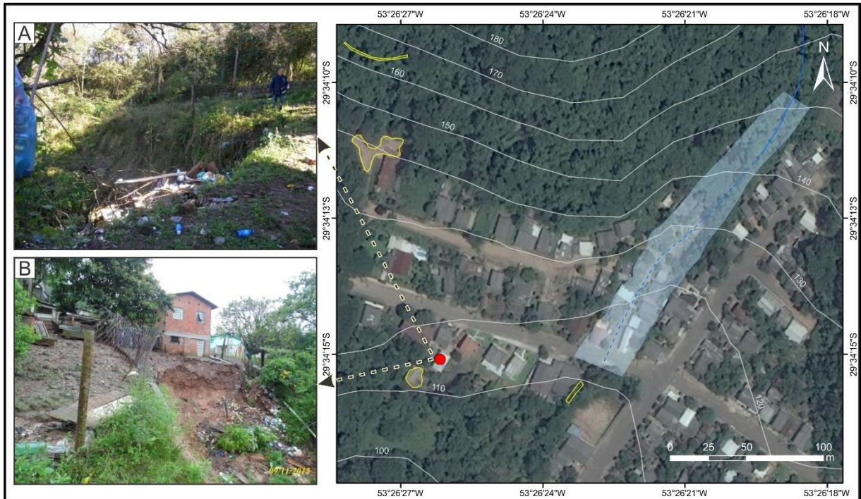
Figura 35 - Situação (II) de perigo muito alto em área onde ocorreu processo de escorregamento rotacional (A e B).
