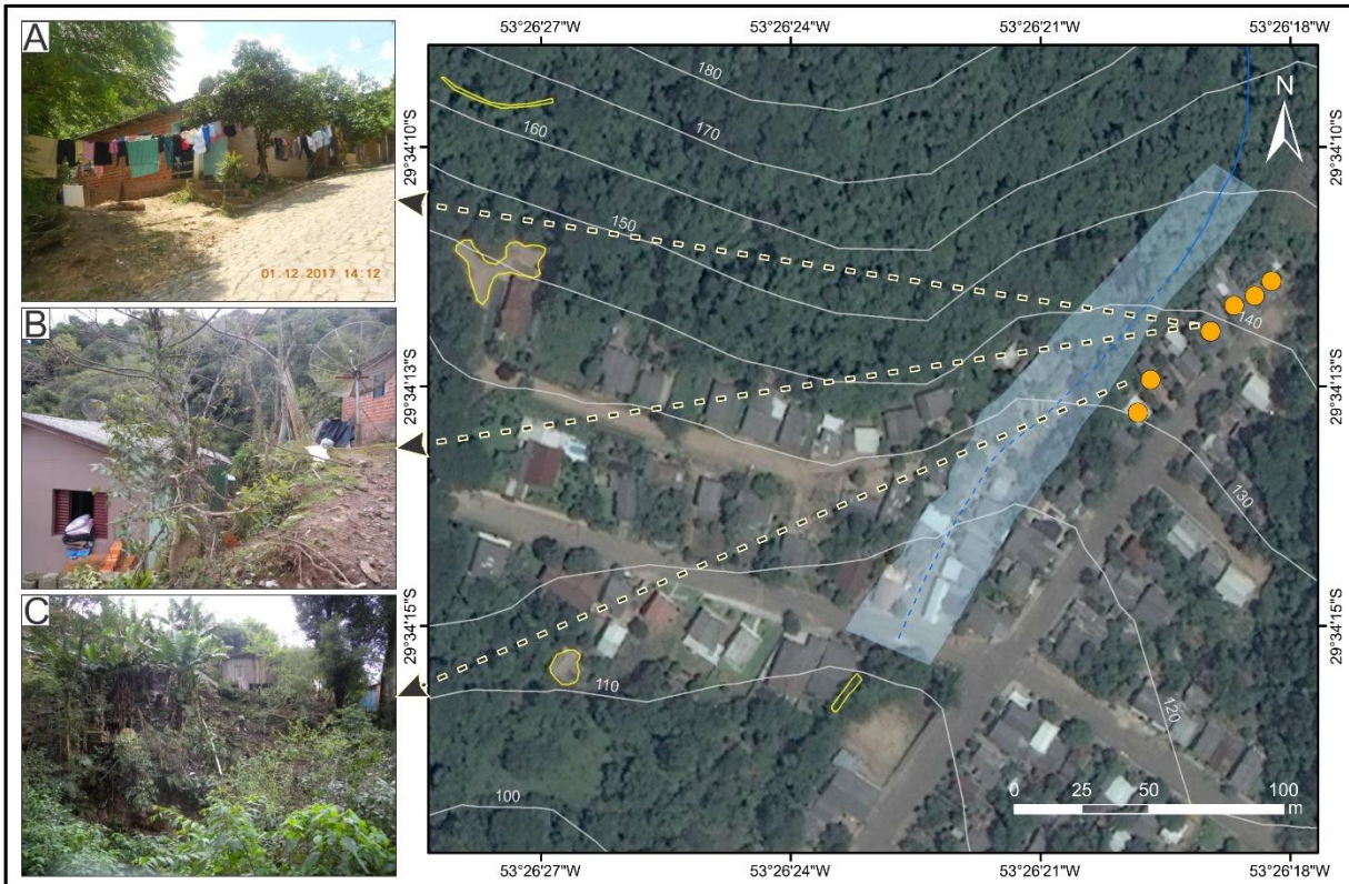
Figura 30 - Situação (III) de perigo alto em área próxima ao vale declivoso e intervenções de corte, aterro, descarte de lixo, lançamento de águas servidas e inserção de espécies exóticas (A, B e C).
