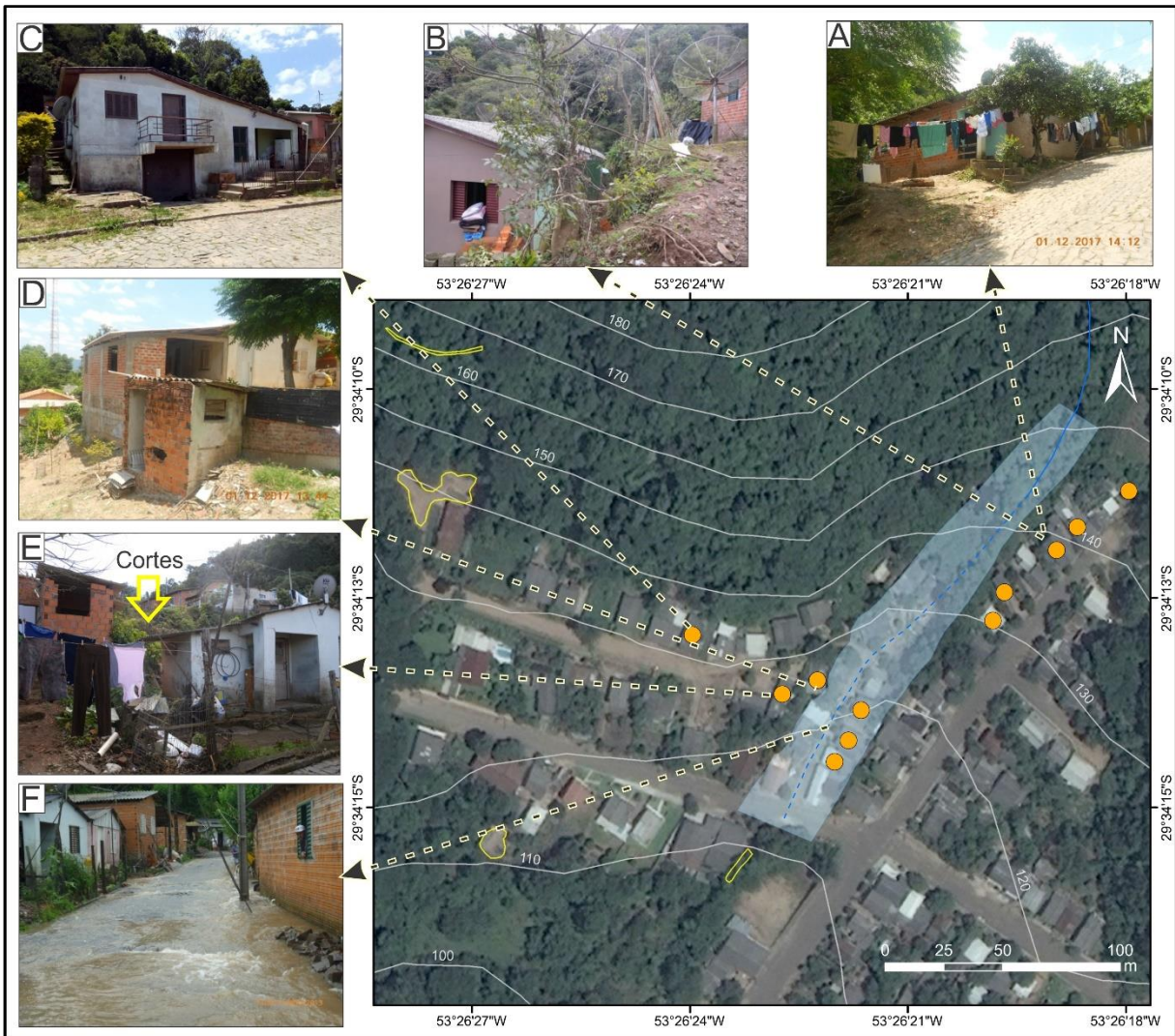
Figura 46 - Situações de risco alto na Vila Medianeira (A, B, C, D, E e F).
