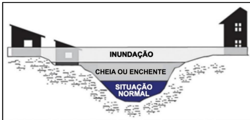
Figura 7 - Perfil esquemático do processo de inundação e cheia ou enchente.
