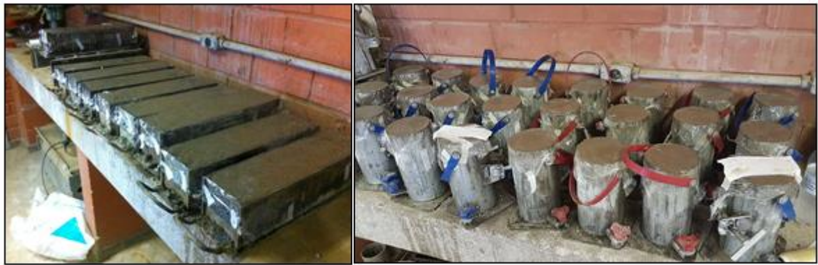
Figura 21 - Desmoldagem do CP 10 x 6 cm
