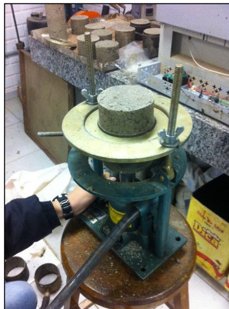
Figura 21 - Desmoldagem do CP 10 x 6 cm
