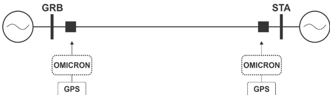
Figura 6.1 - Teste de integração do sistema de proteção de linha
