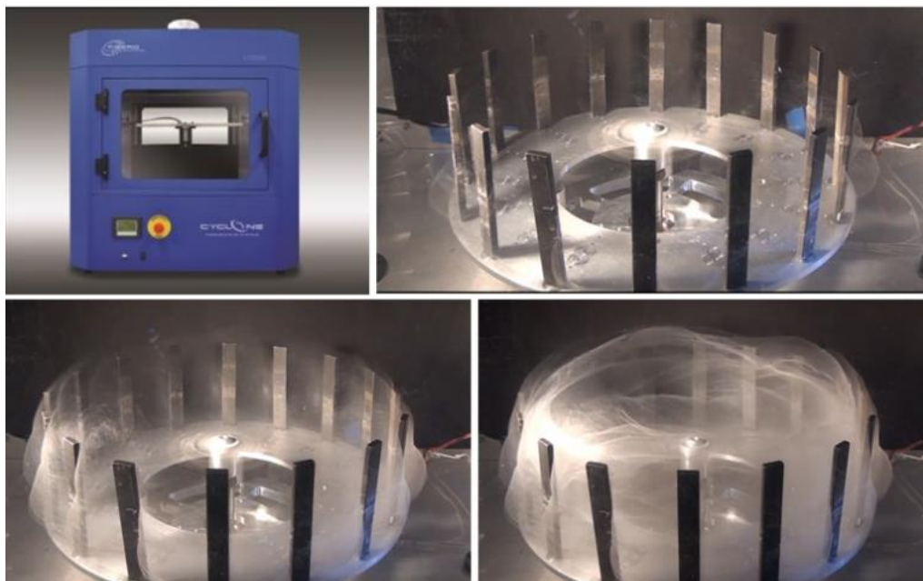
Figura 4: Processo de fabricação de nanofibras utilizando o método de Forcespinning.
