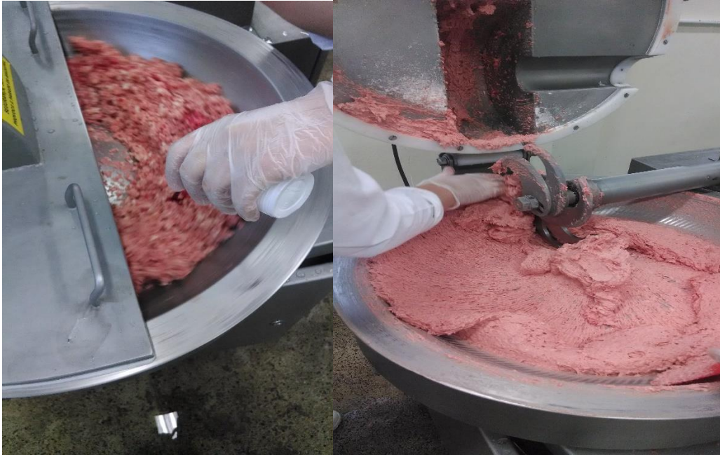
Figura 5 – Etapa de mistura dos ingredientes e aspecto da massa obtida durante preparo em cutter.
