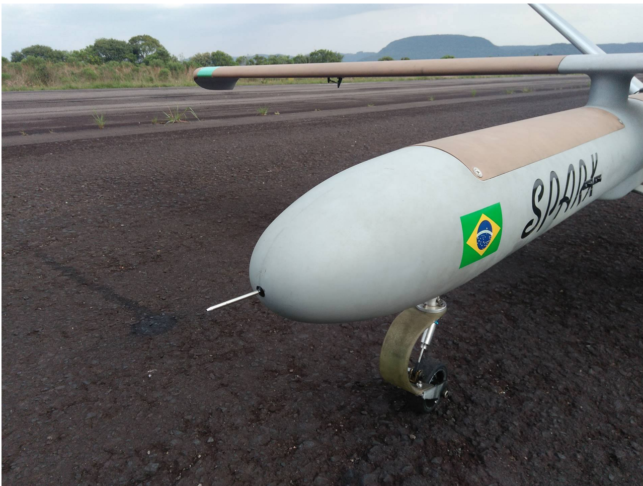
Figura 7.10 – Montagem do Tubo de Pitot
