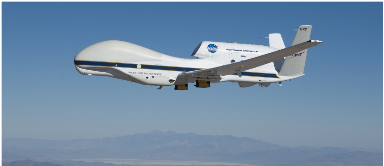
Figura 1.2 – VANT de altitude, raio de ação e autonomia elevada: Global Hawk fabricado pela Northrop Grumman . Fonte: images.google.com
