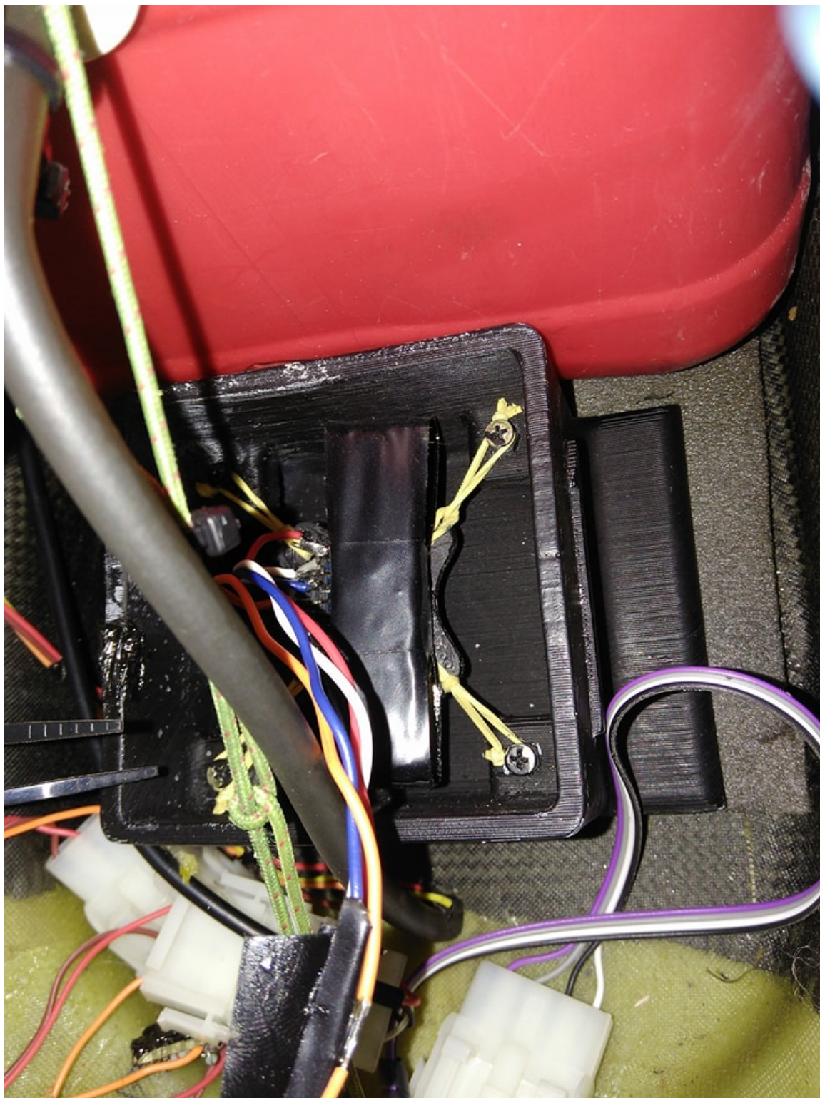
Figura 7.8 – Montagem, perto do CG, do módulo anti-vibração (feito em impressora 3D) com o sensor inercial MPU-6050. Em cima do sensor foi colocado uma massa inercial (pastilhas de chumbo).
