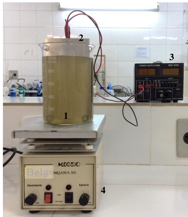
Figura 7 - Reator experimental em escala de bancada: 1 - Reator com efluente; 2 – eletrodos de alumínio; 3 – fonte de alimentação; 4 – agitador magnético.
