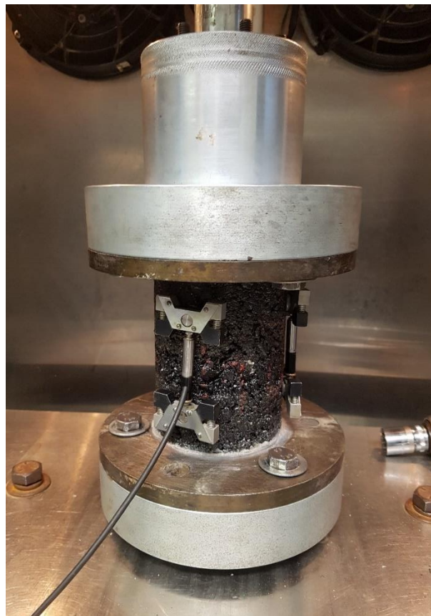
Figura 28 - Realização do ensaio de fadiga tração-compressão uniaxial
