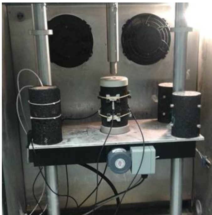
Figura 26 - Realização do ensaio de Módulo dinâmico na prensa UTM-25 no LMCC
