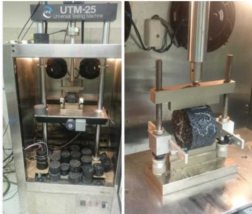
Figura 27 – Realização do ensaio de resistência a tração por compressão diametral na prensa UTM-25
