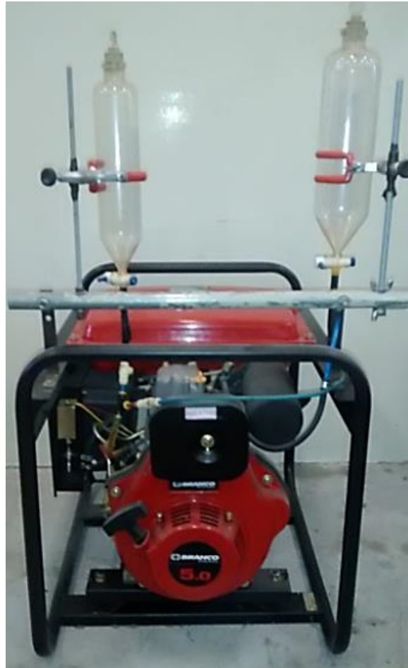
Figura 41 - Sistema de alimentação acoplado ao motor-gerador Branco BD-2500 CF
