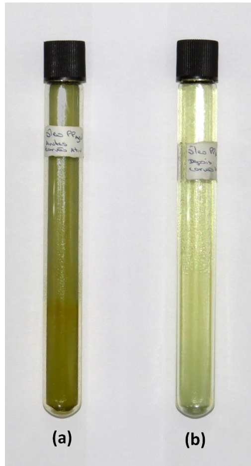
Figura 26 - Óleo da pirólise do PP pós-uso (a) antes e (b) depois da adsorção com carvão ativado/filtro
