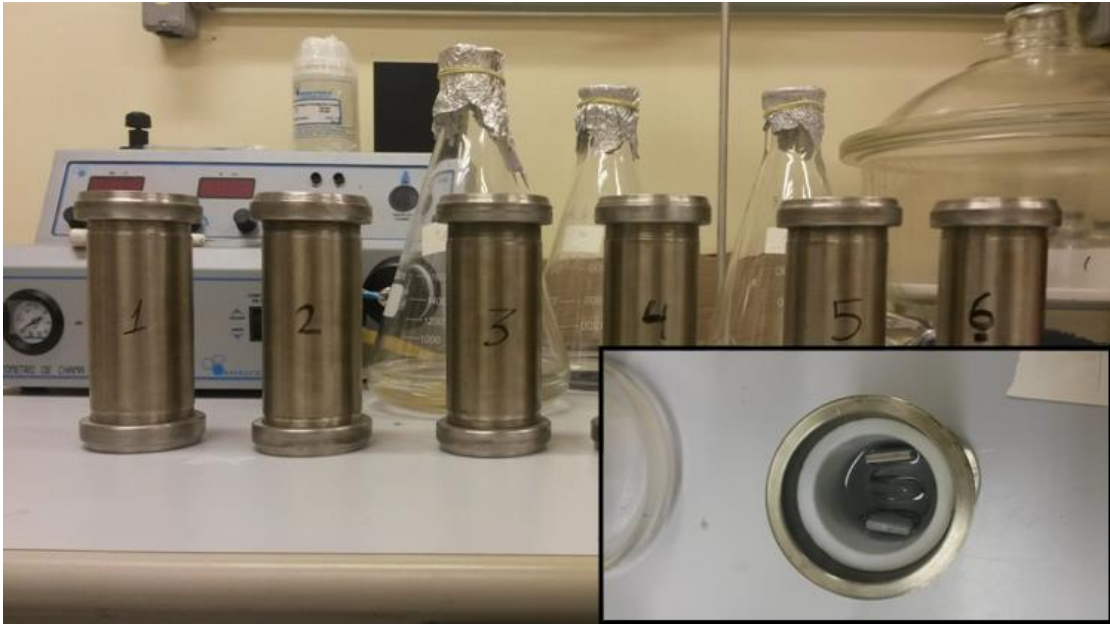
Figura 1. Autoclaves utilizadas nos ensaios de resistência química.
