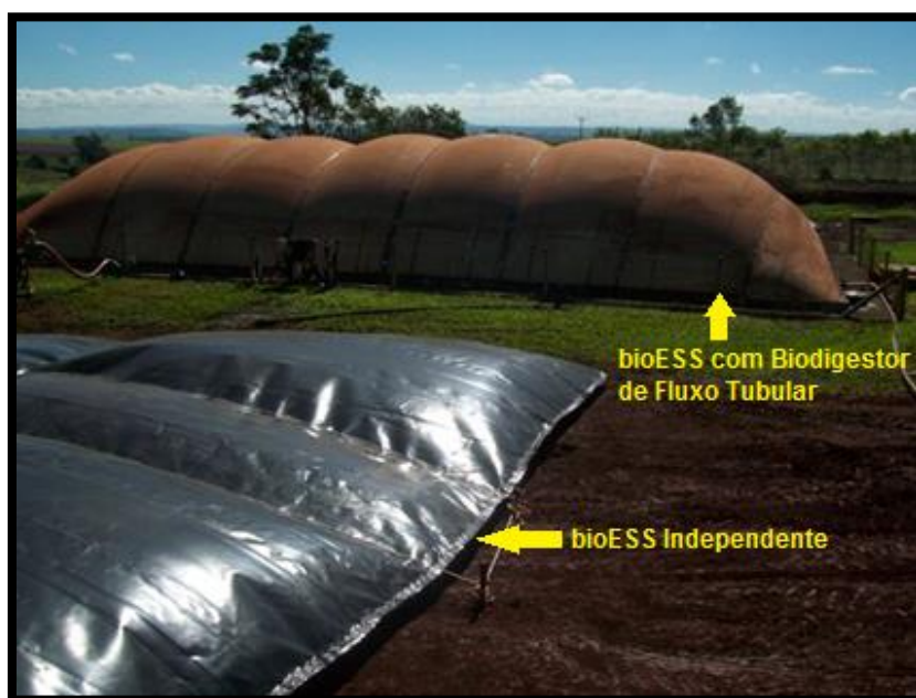
Figura 3.12 - bioESS Tipo Balão Independente Instalado ao lado de um bioESS com Biodigestor de Fluxo Tubular.
