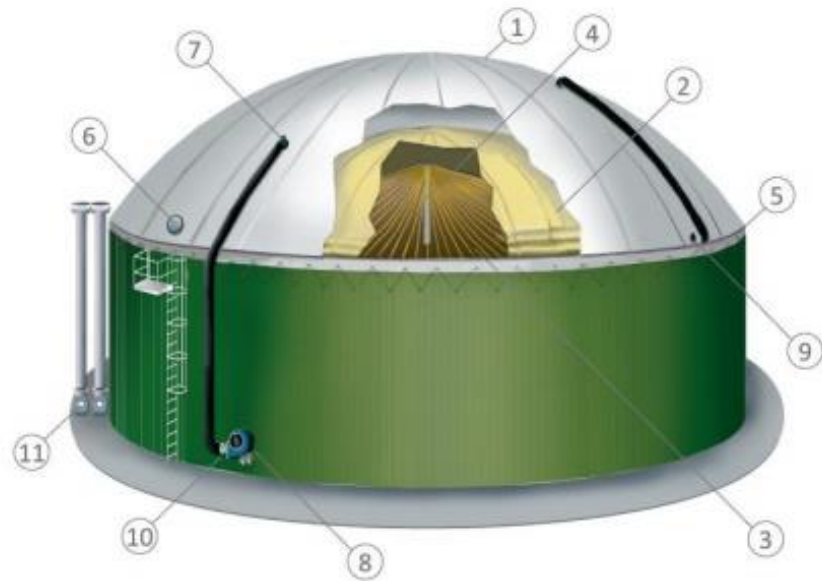
Figura 3.15 - Componentes de um bioESS de Membrana Dupla Montado sobre Tanque
