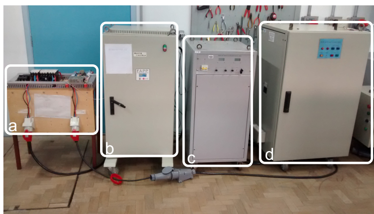
Figura B.1 – Ilustração do protótipo: a) indutores para ensaio de variação paramétrica, b) Módulo inversor e filtro LCL, c) fonte de tensão CC e d) VARIAC para conexão com a rede.
