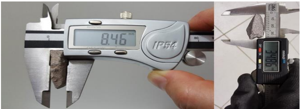
Figura 3.11 - Medição do comprimento e espessura das partículas com uso do paquímetro
