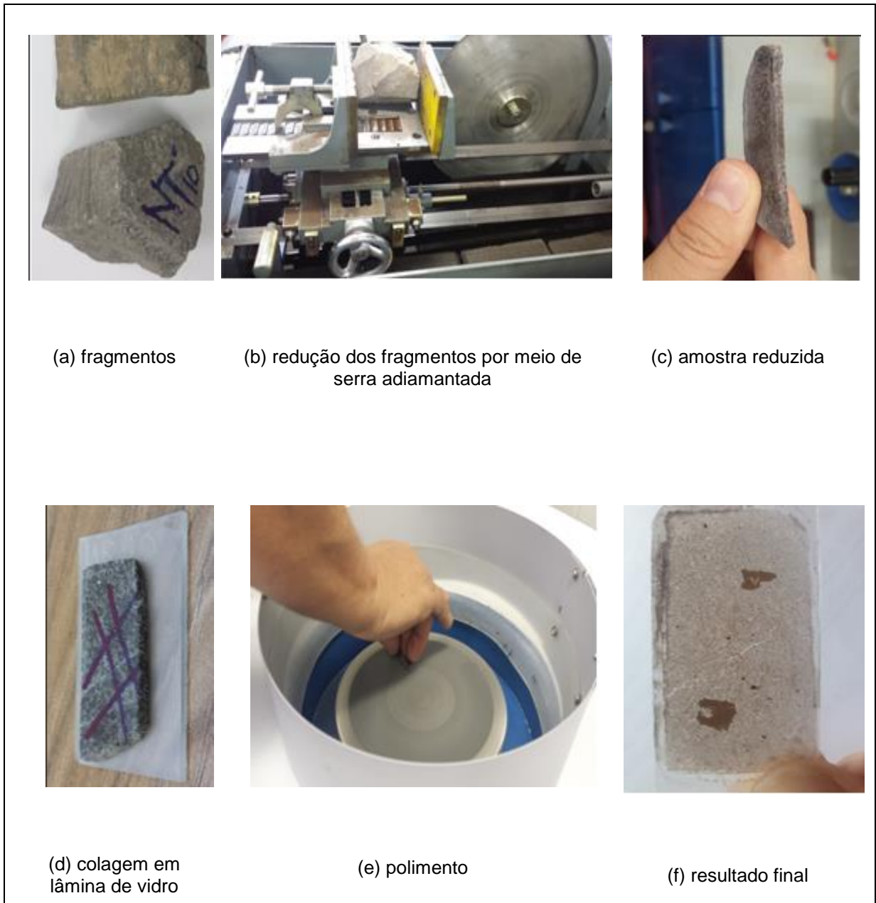
Figura 3.8 - Processo para fabricação de lâminas delgadas
