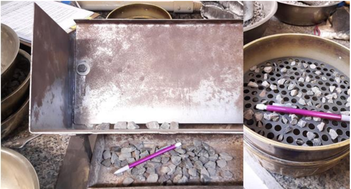
Figura 3.12 – Determinação do Índice de Forma com uso de crivos
