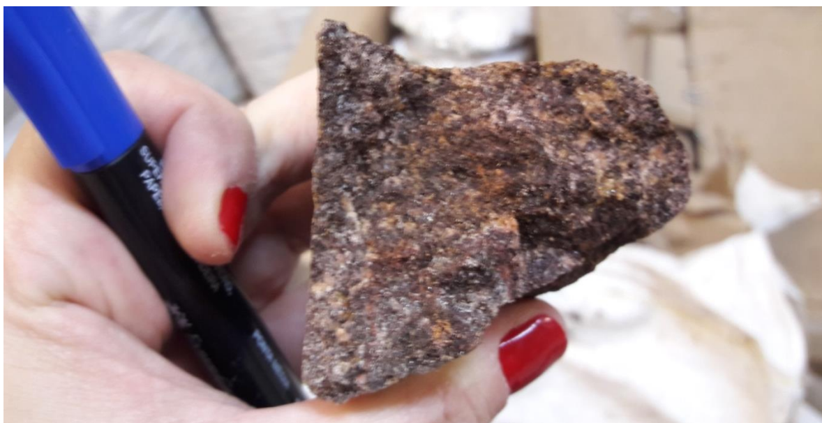
Figura 4.33 – Amostra saturada da jazida COT com pior índice de compressão pontual de 0,8 Mpa.
