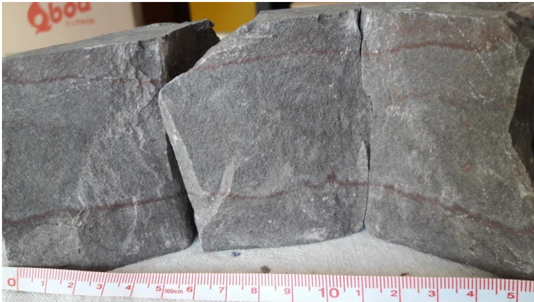
Figura 4.29 – Amostra seca da jazida PIN com rompimento perpendicular as linhas de fratura.
