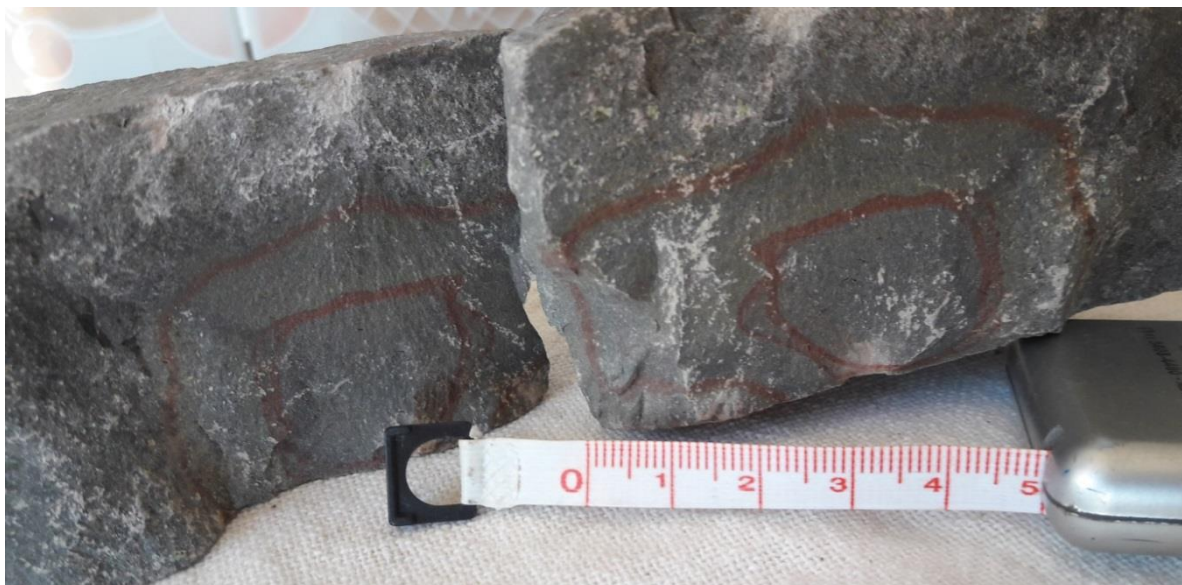
Figura 4.31 – Amostra saturada da jazida PAI rompida de forma perpendicular a possível face direção de fluxo
