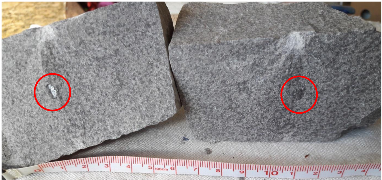
Figura 4.30 – Amostra seca da jazida PIN com presença de vesícula preenchida por zeólita.
