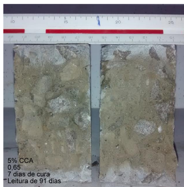
Figura 18 - Corpo de prova com penetração de íons cloreto
