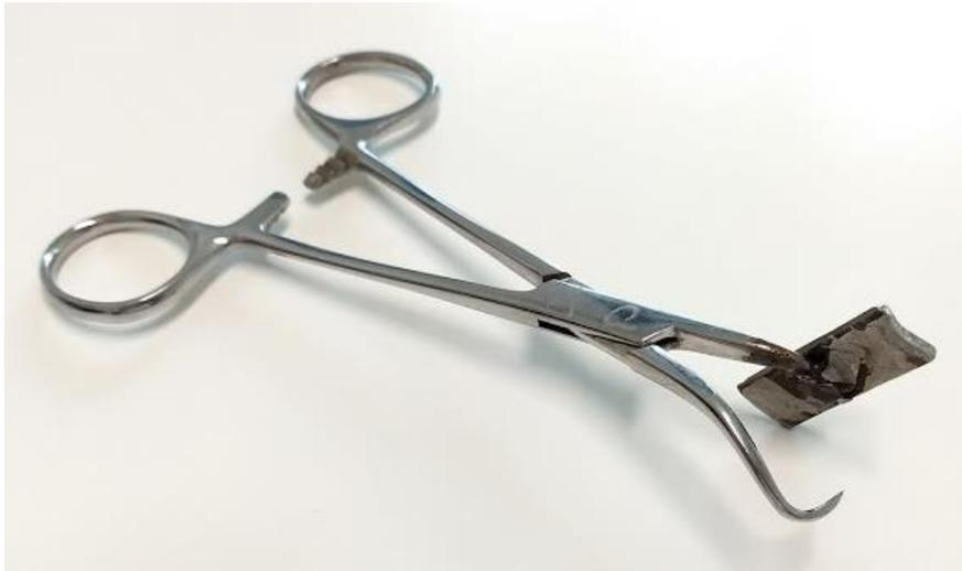
Figura 1. Fraturador Experimental Minimamente Invasivo (FEMI), produzido mediante modificação de uma pinça de Backhaus, o qual permite a produção fechada de fraturas em costelas de cães e gatos, mediante aplicação de braço de alavanca.
