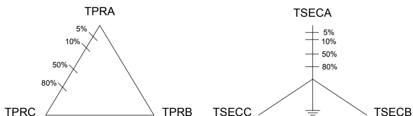
Figura 21 - Divisão em porcentagem dos enrolamentos primário ( \Delta ) e secundário (Y).
