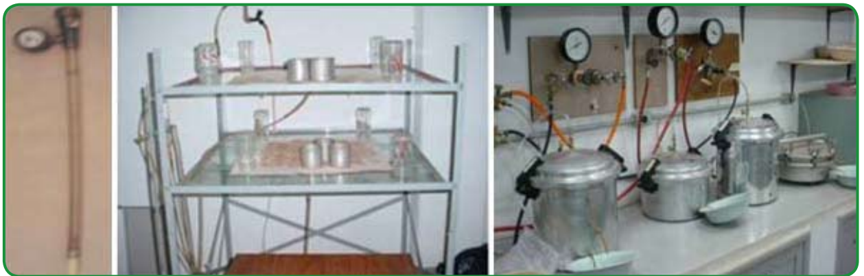
Figura F.8 - Equipamentos usados na determinação do potencial matricial de água no solo: tensiômetro (à esquerda), mesa de tensão (ao centro) e câmaras de pressão (à direita).
