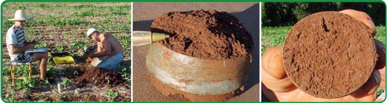
Figura F.5 - Coleta de uma amostra de solo para as determinações massa-volume. Após extraída do solo (foto à esquerda), o excesso de solo (ao centro) é removido cuidadosamente (à direita) para que o volume do anel ( V_c ) corresponda exatamente ao volume de total amostra de solo ( V_t ).
