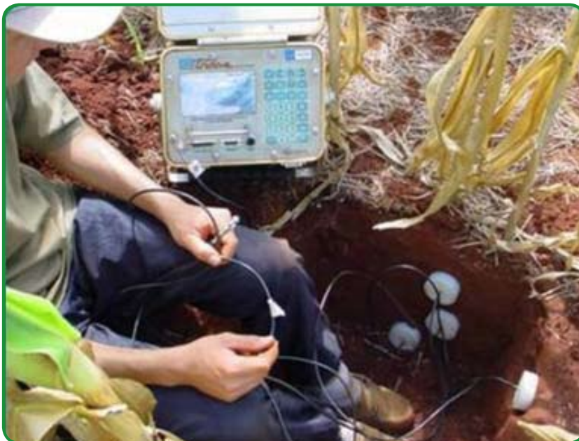
Figura F.7 - TDR sendo instalado no campo para a medição da umidade volumétrica do solo.
