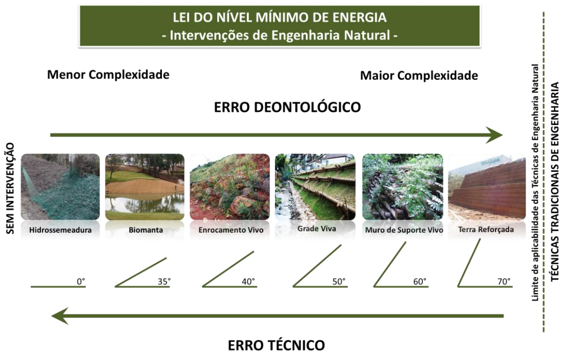
Figura 5 - Esquema representativo do nível mínimo de energia em intervenções de Engenharia Natural.
