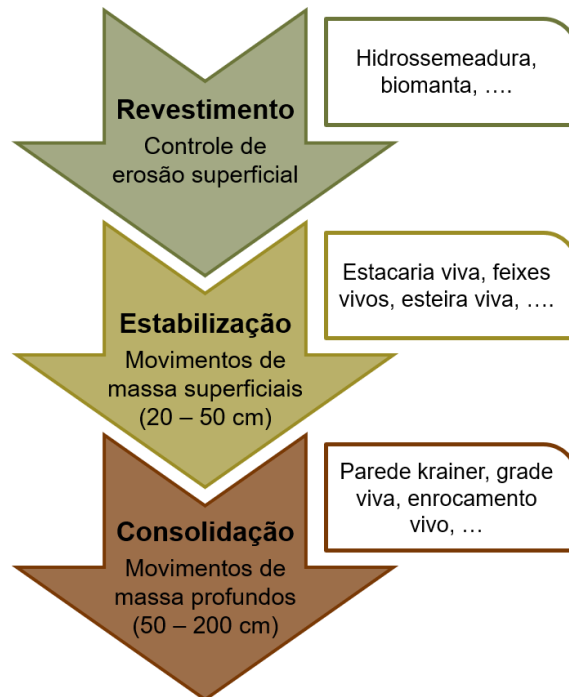
Figura 1 - Esquema simplificado das tipologias construtivas existentes em Engenharia Natural.
