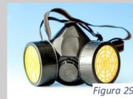
Se o ar soprado não sair é porque ficou bem ajustada. Caso contrário, faça ajustes puxando as fivelas e testando a vedação. Esta máscara possui filtros específicos com prazo de validade que devem ser observados sempre, bem como não podem ser molhados. Após o uso a máscara deve ter seus filtros retirados e guardados e local seco e o restante deve ser lavado com água corrente.
