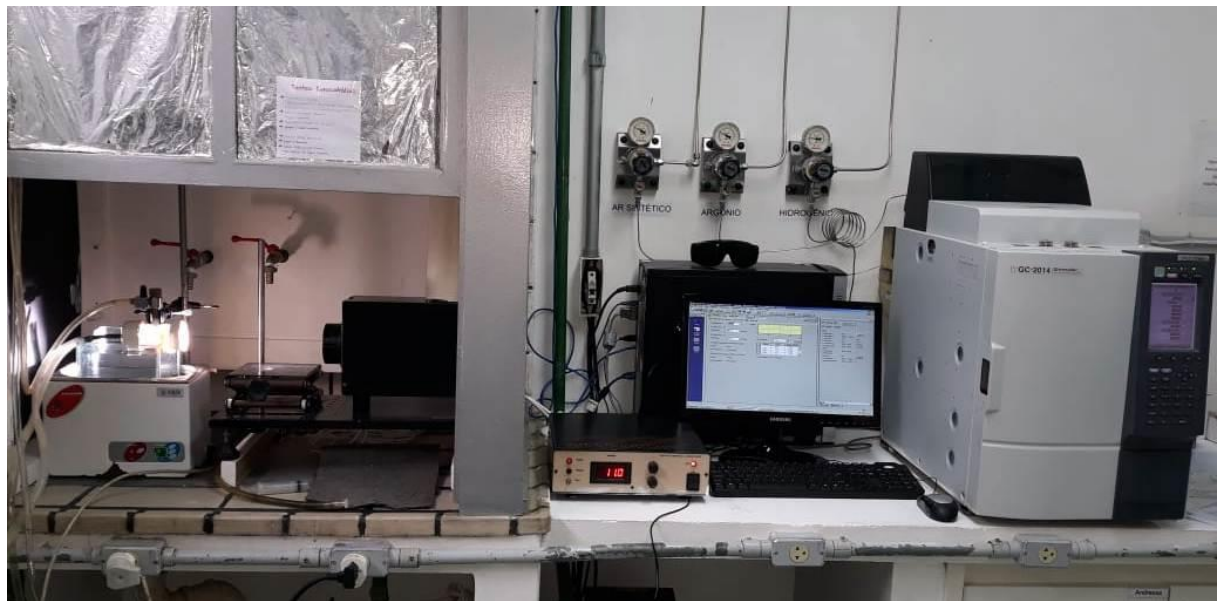
Figura 10. Sistema utilizado nos experimentos de fotocatalise: (a) reator de teflon com janela de quartzo; (b) simulador solar; (c) controlador de potência do simulador solar; (d) cromatógra.
