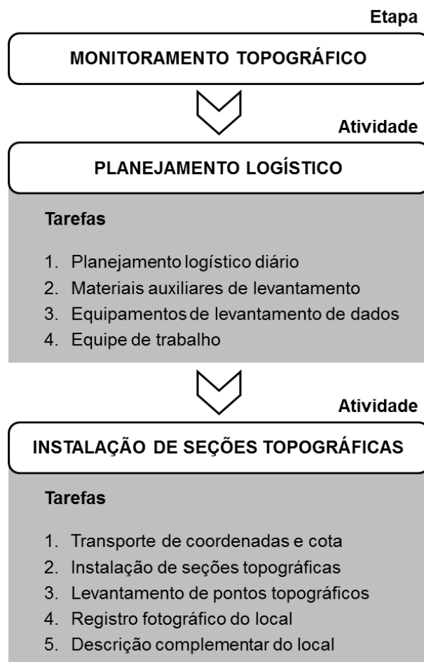
Figura 38 - Fluxograma de atividades e tarefas envolvidas na etapa de monitoramento topográfico do monitoramento de processos erosivos.
