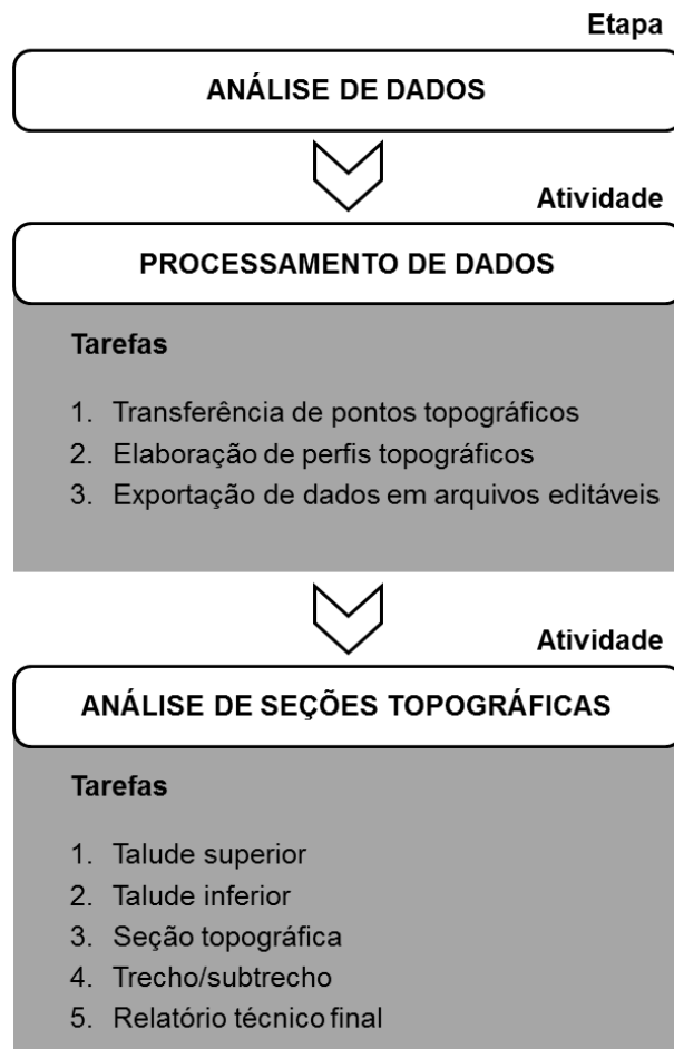
Figura 43 - Fluxograma de atividades e tarefas envolvidas na etapa de análise de dados do monitoramento de processos erosivos.
