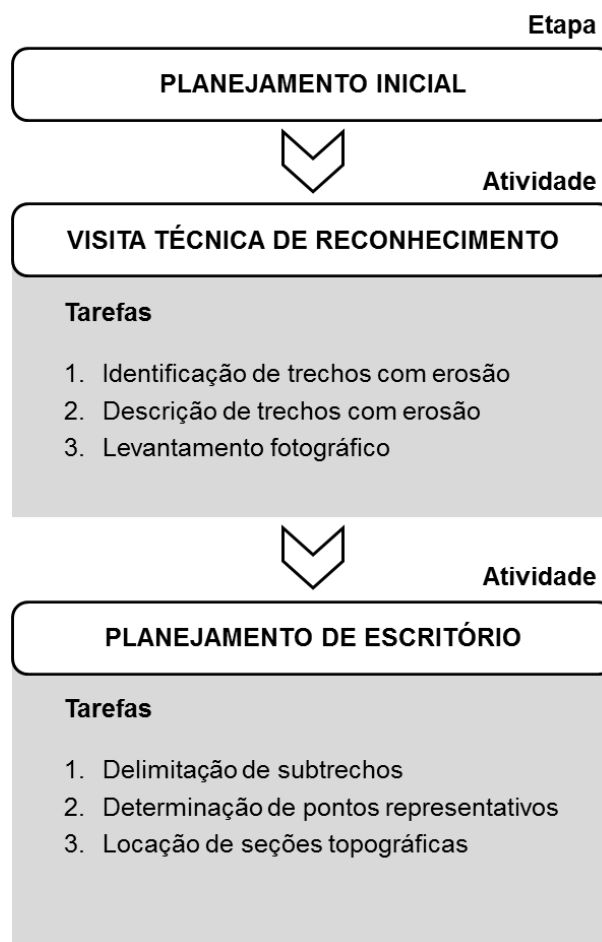
Figura 25 – Fluxograma de atividades e tarefas envolvidas na etapa de planejamento inicial do monitoramento de processos erosivos.
