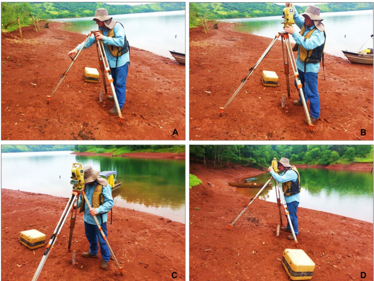
Figura 35 – Procedimento de instalação de estação total. (A) posicionamento e nivelamento do tripé; (B) pré-posicionamento da estação total; (C) nivelamento e posicionamento da estação total sobre o tripé e o piquete, respectivamente e (D) coleta de pontos sobre o alinhamento da seção topográfica.
