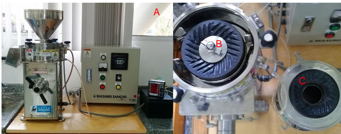
Figura 8 - Moinho desfibrilador (A); Disco de pedra rotativa (B); Disco de pedra estática (C)
