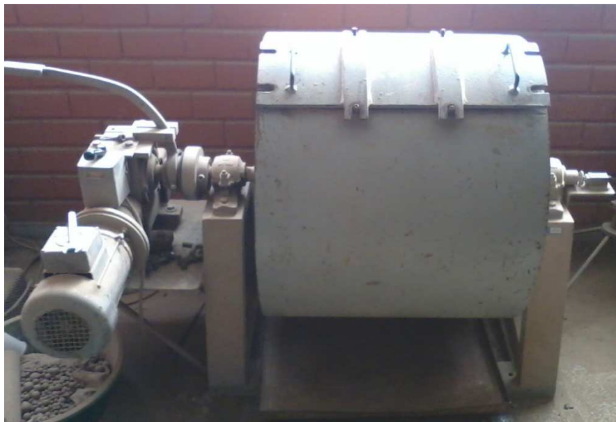
Figura 24: Equipamento de abrasão Los Angeles da UFSM
