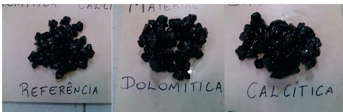
Figura 36: Ensaio de adesividade com agregados de Sarandi
