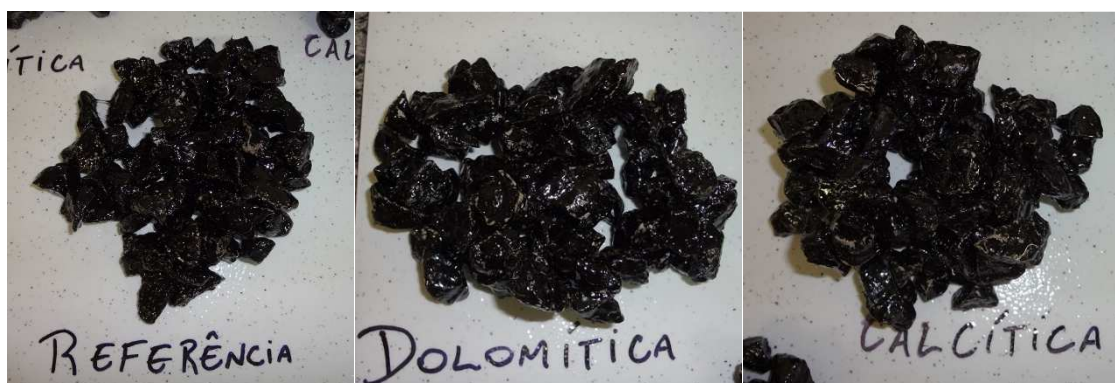
Figura 33: Ensaio de adesividade com agregados de Bagé
