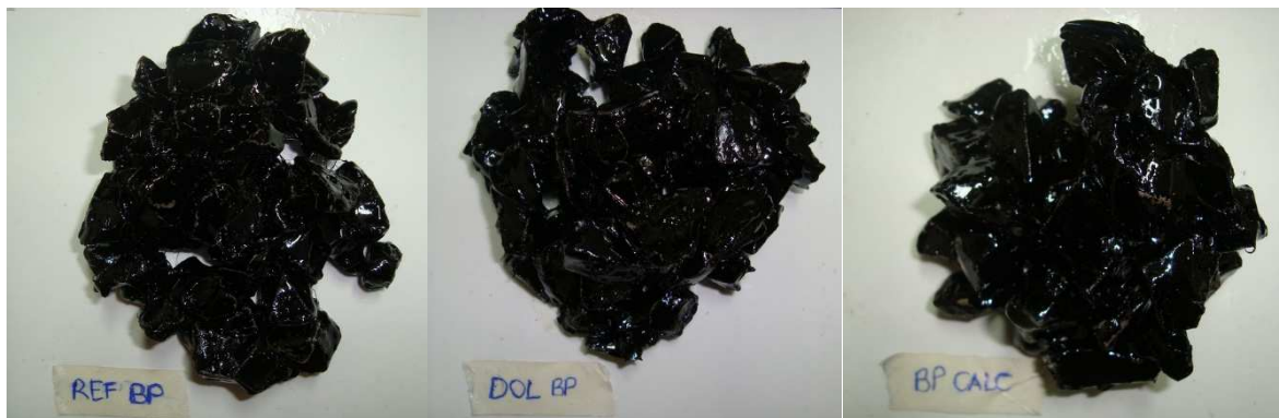
Figura 32: Ensaio de adesividade com agregados de Itaara
