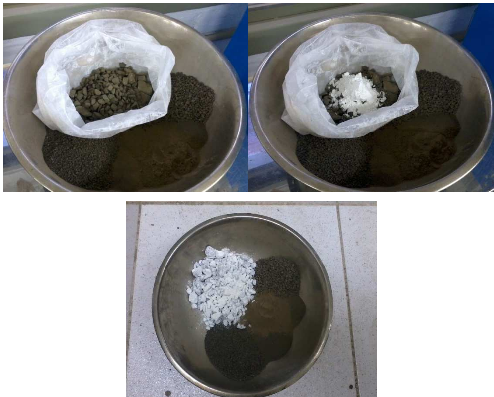
Figura 19: Esquema de adição de cal na mistura
