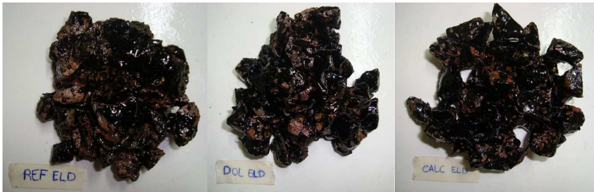
Figura 31: Ensaio de adesividade com agregados de Eldorado do Sul
