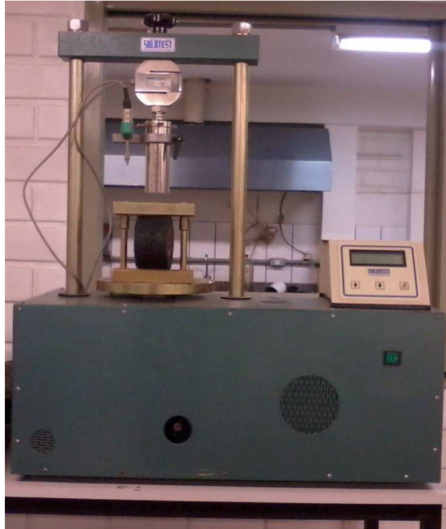
Figura 23: Equipamento para ensaio de Rt.
