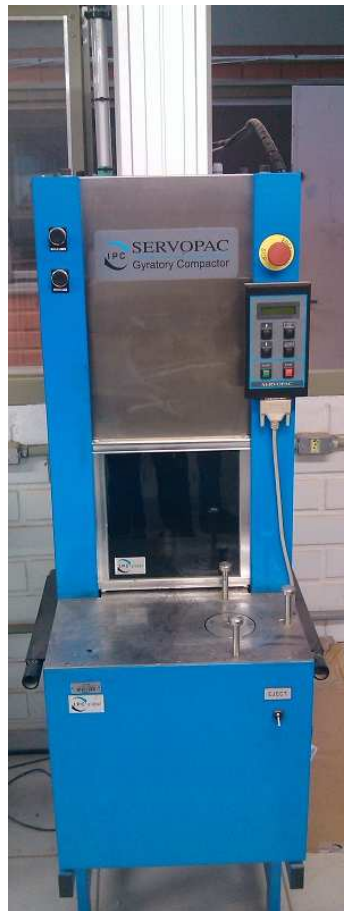
Figura 3: Exemplo de um Compactador giratório – Laboratório de Materiais de Construção Civil da UFSM
