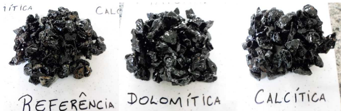
Figura 34: Ensaio de adesividade com agregados de Caçapava do Sul
