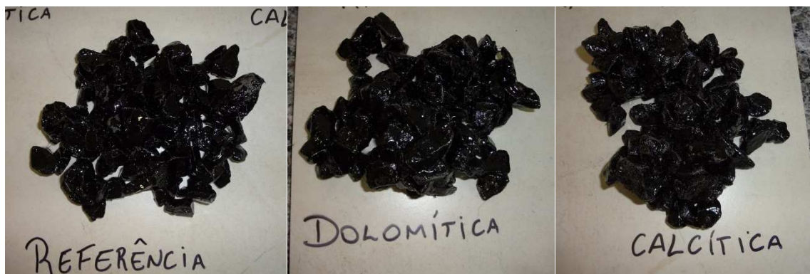
Figura 35: Ensaio de adesividade com agregados de Santo Antônio da Patrulha
