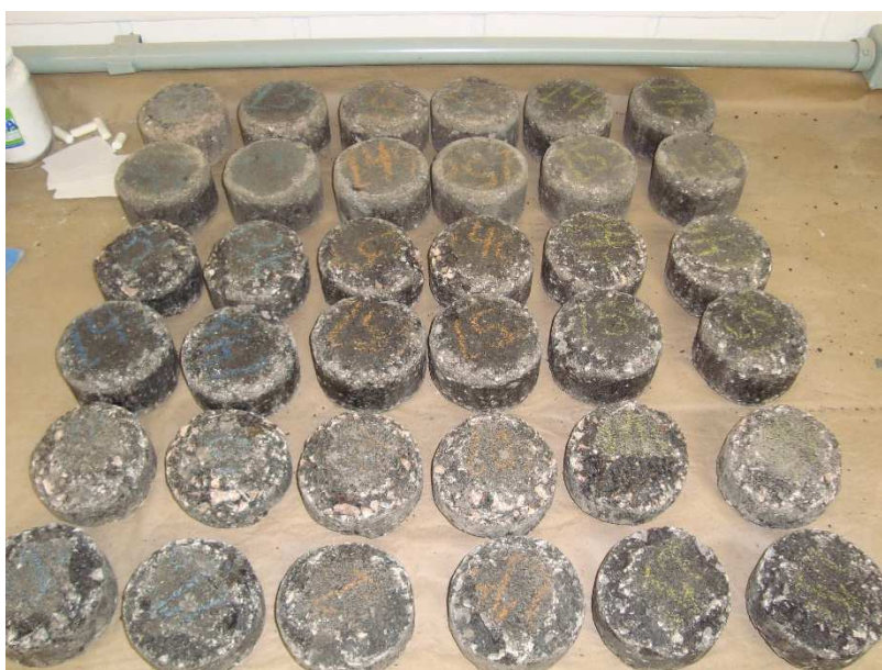
Figura 30: Amostras ensaiadas em diferentes temperaturas
