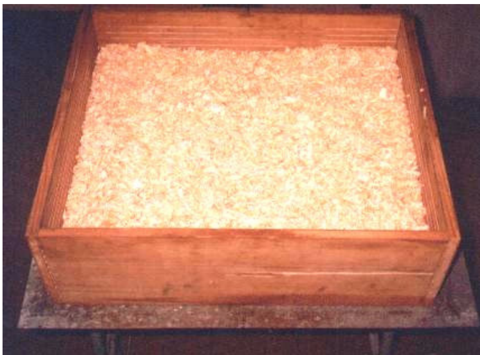
FIGURA 4. - Formação do colchão de partículas
