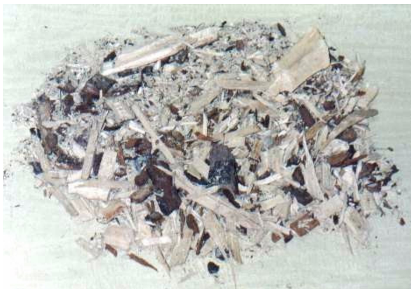
FIGURA 1. Detalhe da amostra de resíduos de serraria na forma original
