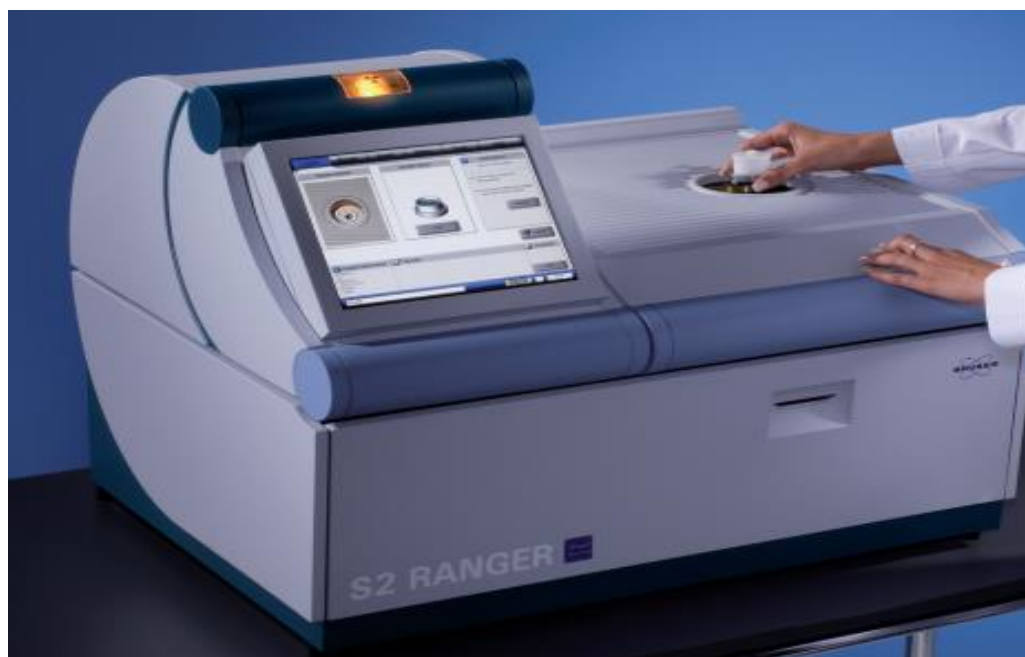
Figura 16 – Espectrômetro de fluorescência de raios X por energia dispersiva.
