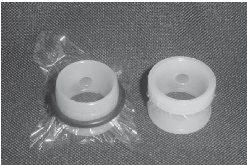
Figura 17 – Celas de polietileno equipadas com película polimérica para análises por fluorescência de raios X.
