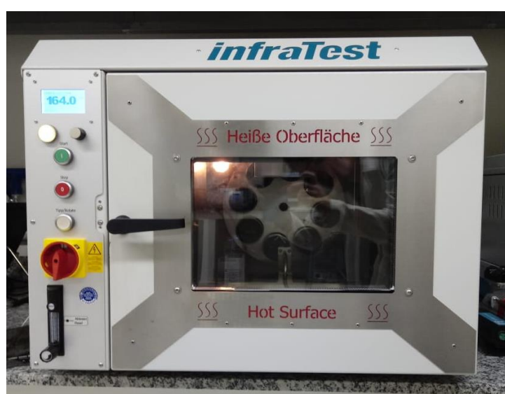
Figura 12 – Equipamento utilizado para o ensaio de envelhecimento RTFOT.
