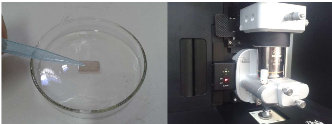
Figura 10. Deposição de amostra sobre superfície de mica e microscópio de força atômica Park NX10.
